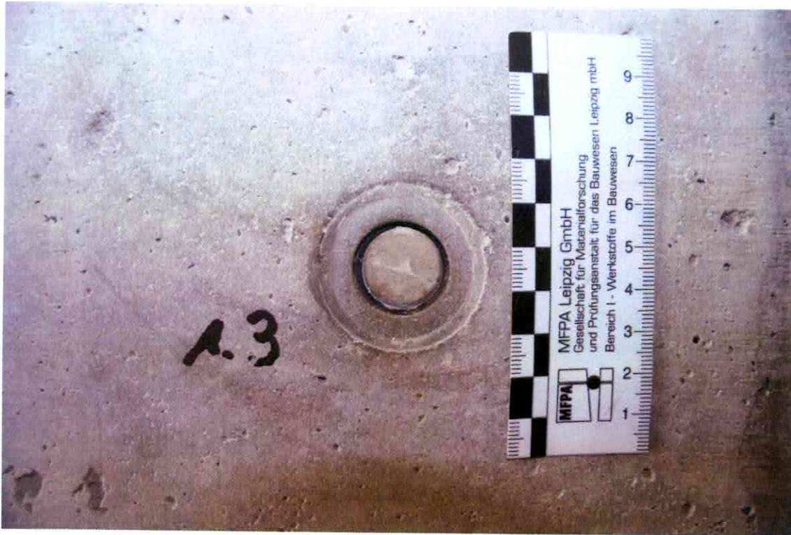
Bild 3: Verschlussstopfen des Probekörper 1.3 nach erfolgter Druckprüfung
