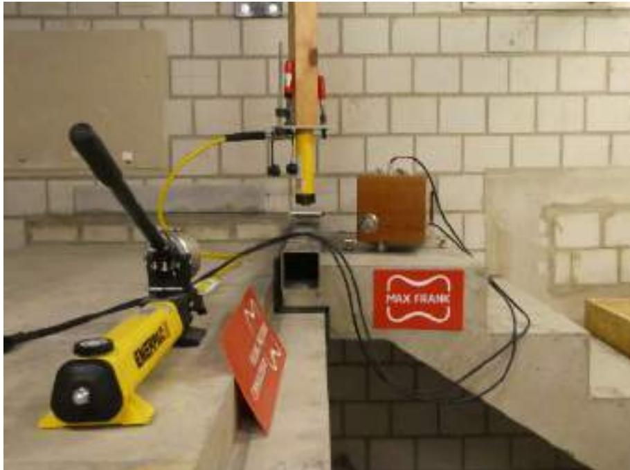
Abbildung 37: Hydraulischer Stempel zum Aufbringen der Zusatzlasten auf den Lauf (Konfiguration 1)
