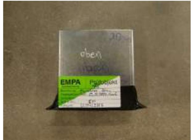
Abbildung 13: Podestlager Egcpopal SP mit 20mm Elastomerlager (mit alter Bezeichnung auf dem Prüfetickett)
