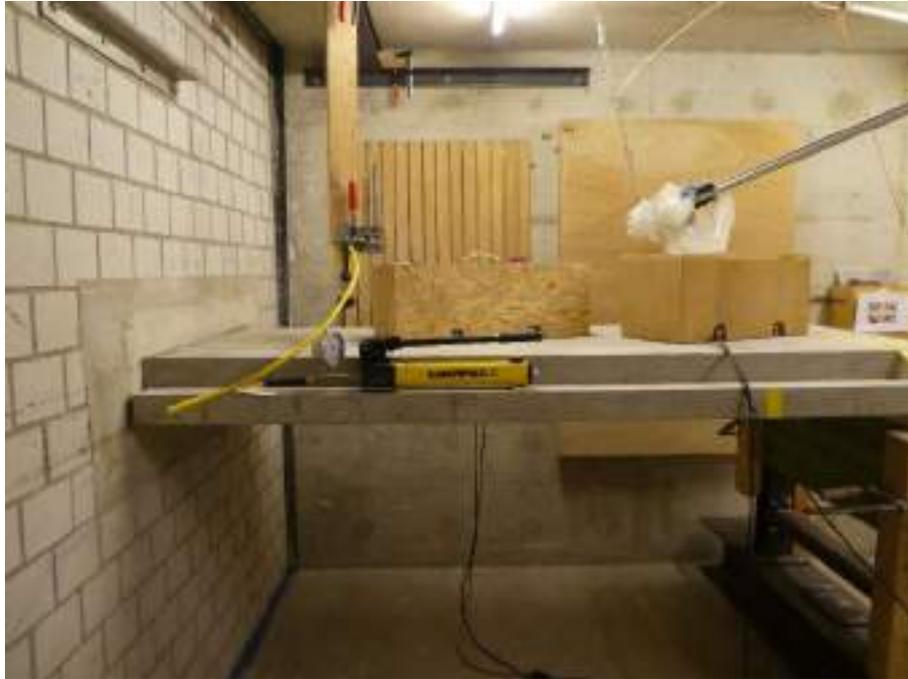
Abbildung 42: Übersicht der Einbausituation und Hammerwerkspositionen auf dem Podest
