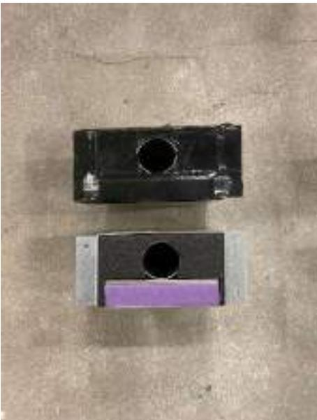
Abbildung 14: Podestlager Egcpopal SP light mit 20mm Elastomerlager
