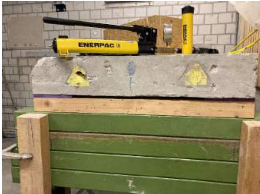
Abbildung 30: Hilfswand als Auflager des Referenzpodests 1 zur Prüfung von Podestlagern (Konfiguration 2)
