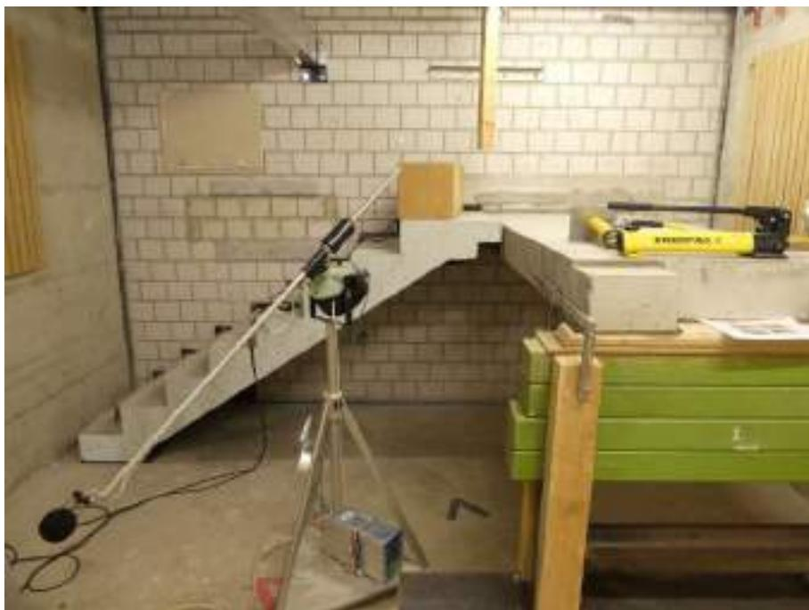
Abbildung 29: Zweite Anordnung zur Prüfung von Treppenlagern und Podestlagern (Konfiguration 2)
