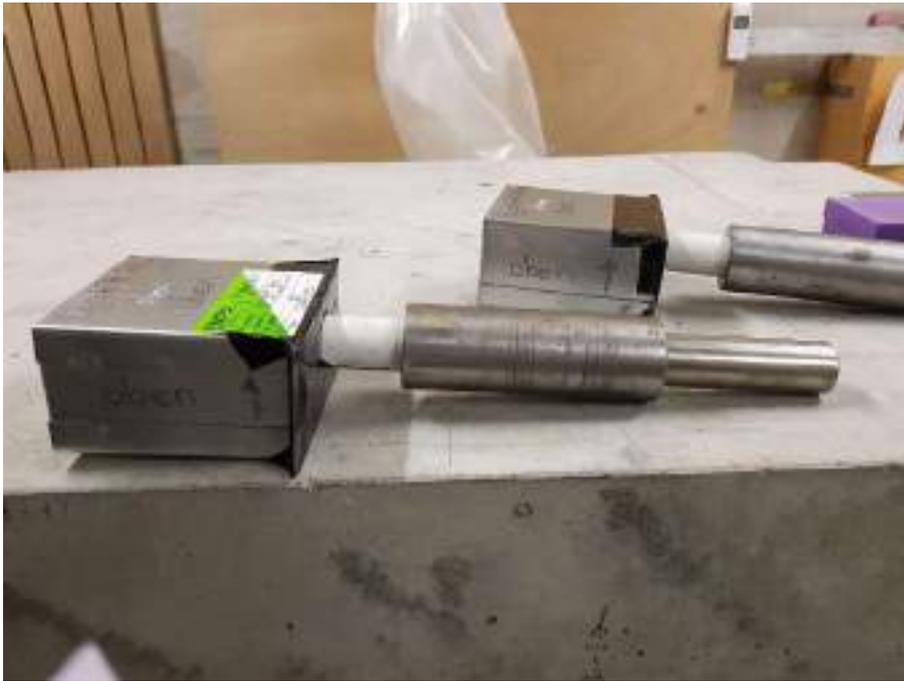
Abbildung 22: Podestlager Egcpal SP mit 20mm Elastomerlager mit Dorn und Adapterhülse vor dem Einbau
