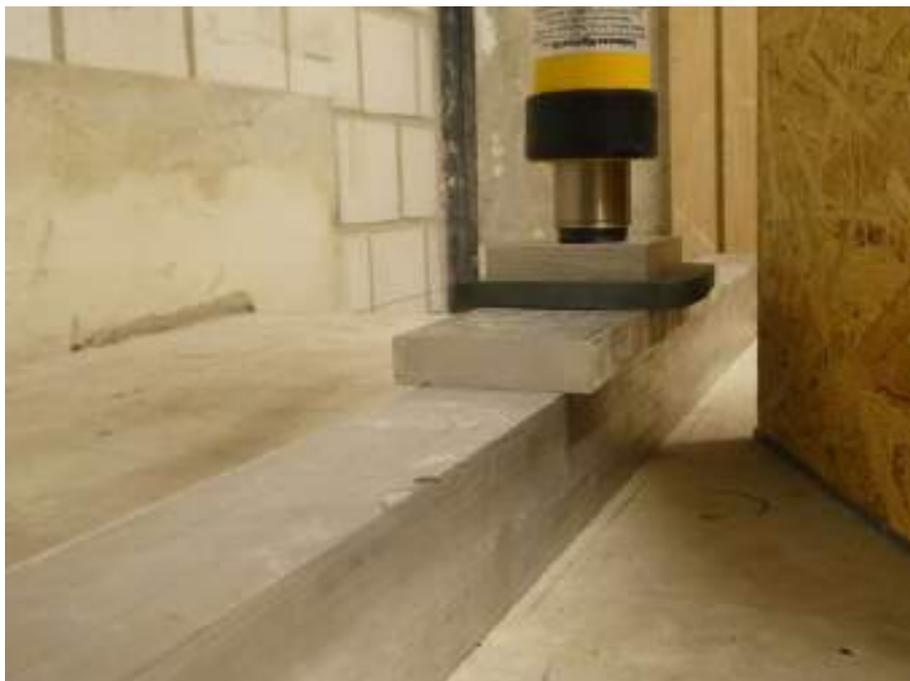
Abbildung 38: Aufbringen der Zusatzlast auf das Podest (Konfiguration 2)
