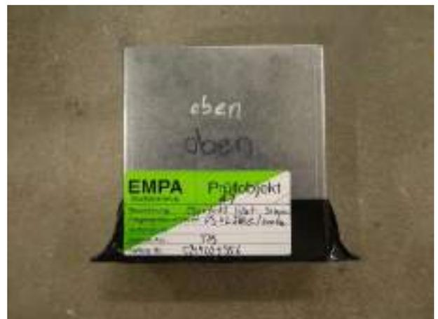
Abbildung 15: Podestlager Egcpopal SP light mit 20mm Elastomerlager (mit alter Bezeichnung auf dem Prüfetickett)
