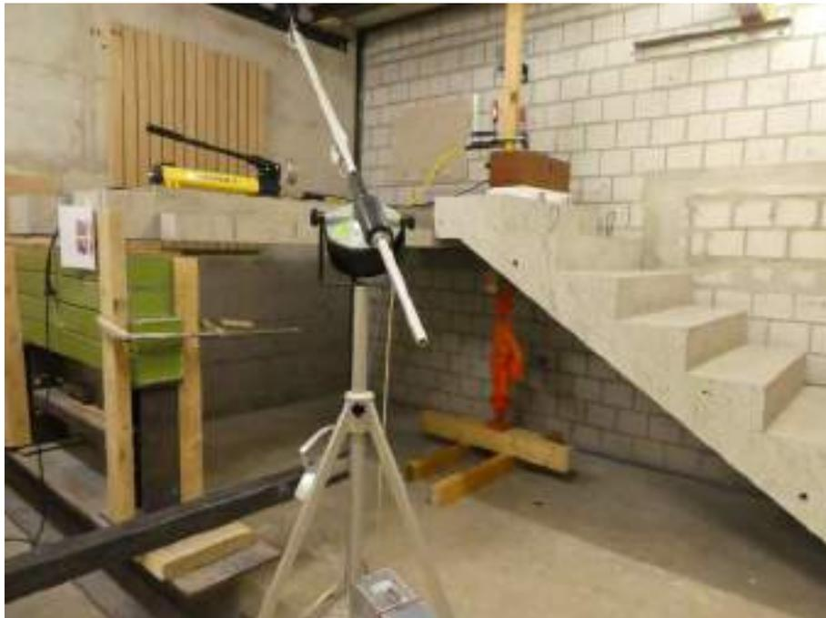
Abbildung 28: Erste Anordnung zur Prüfung von Treppenlagern (Konfiguration 1)
