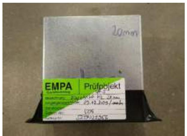
Abbildung 11: Podestlager Egcopal SPH mit 20mm Elastomerlager (mit alter Bezeichnung auf dem Prüfeticket)
