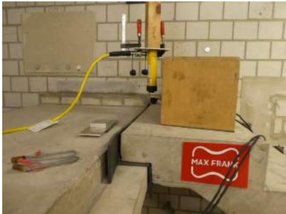
Abbildung 40: Position und Kapselung des Hammerwerks auf Referenzlauf 1
