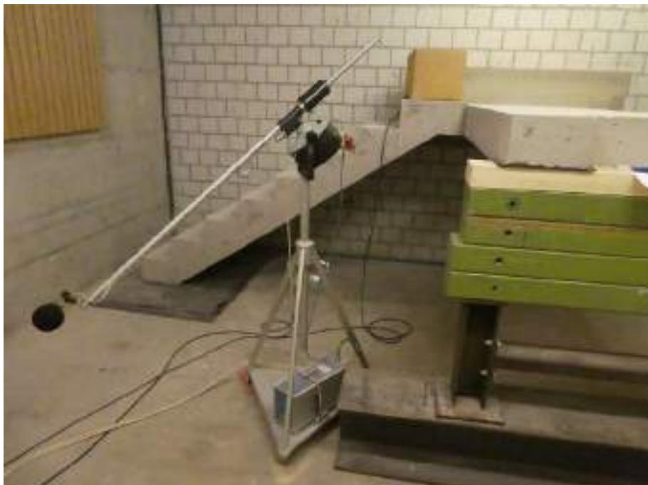
Abbildung 36: Vor Ort gegossener Verbund aus Treppenlauf und -podest. Oberhalb des Podests ist die Aussparung zu erkennen, die nach Einsetzen des Podests zubetoniert wurde.
