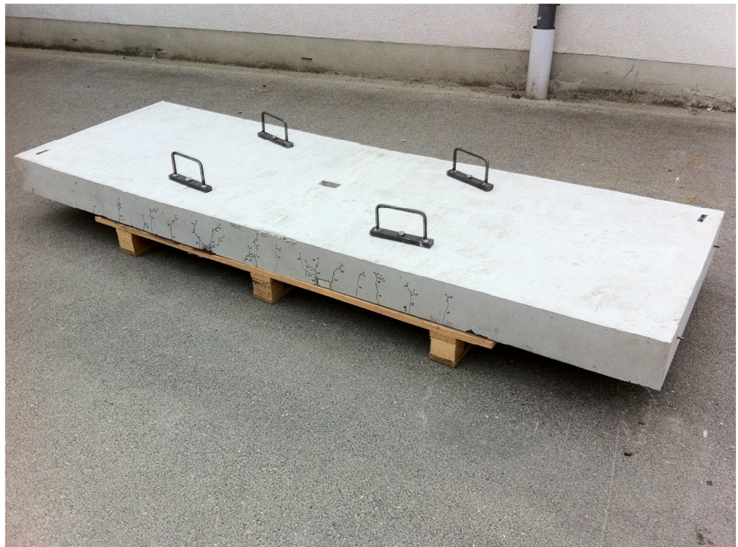
Bild 5 Probekörper V2 mit Sorp10 nach durchgeführtem Versuch bis zum Versagen.
