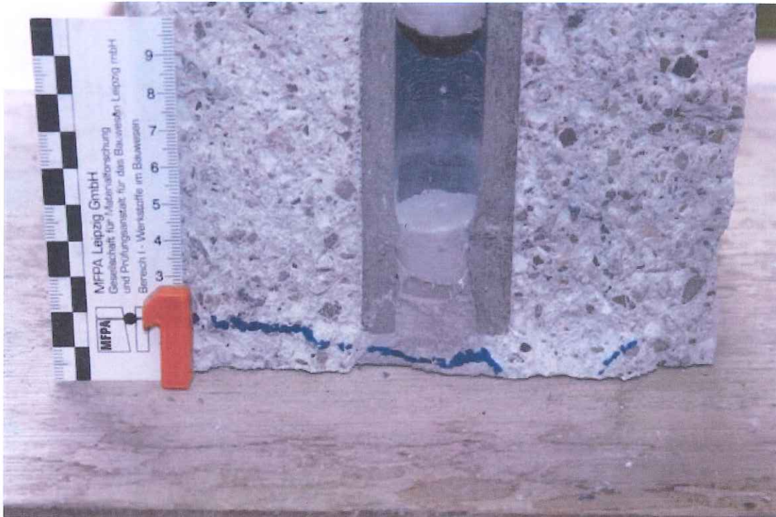
Bild 1: Serie B „FRANK-Faserbeton-Mauerstärken – MR 22 mit einem FB-Stöpsel St220020 und einen FB-Konus mit Zapfen FBVKZ22, Probe 1
