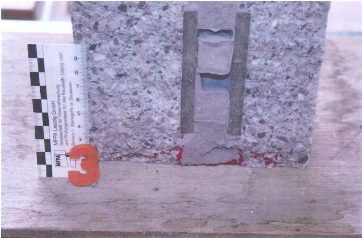
Bild 3: Serie C „FRANK-Faserbeton-Mauerstärken – MR 22 verschlossen mit einem FB-Stöpsel St220020 und einen 3 cm-Konus mit Zapfen FBVKZ22T, Probe 3
