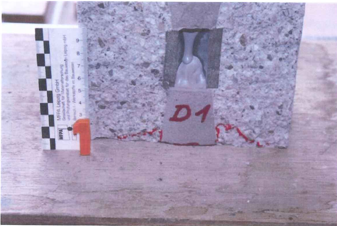
Bild 1: Serie D „FRANK-Faserbeton-Mauerstärken – MR 22 verschlossen mit je einem 5 cm-Konus FBVK22T50, Probe 1
