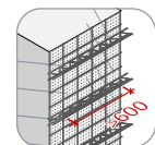
Vyztužení + zpětné kotvení b > 600 \text{ mm}
