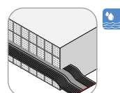
S armokošem pro těsnící pás
