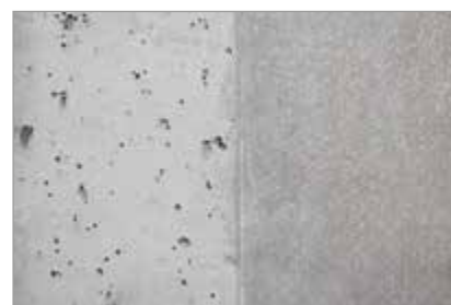
ohne Zemdrain® (links) vs. mit Zemdrain® (rechts)
