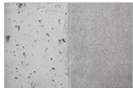
ohne Zemdrain® (links) vs. mit Zemdrain® (rechts)
